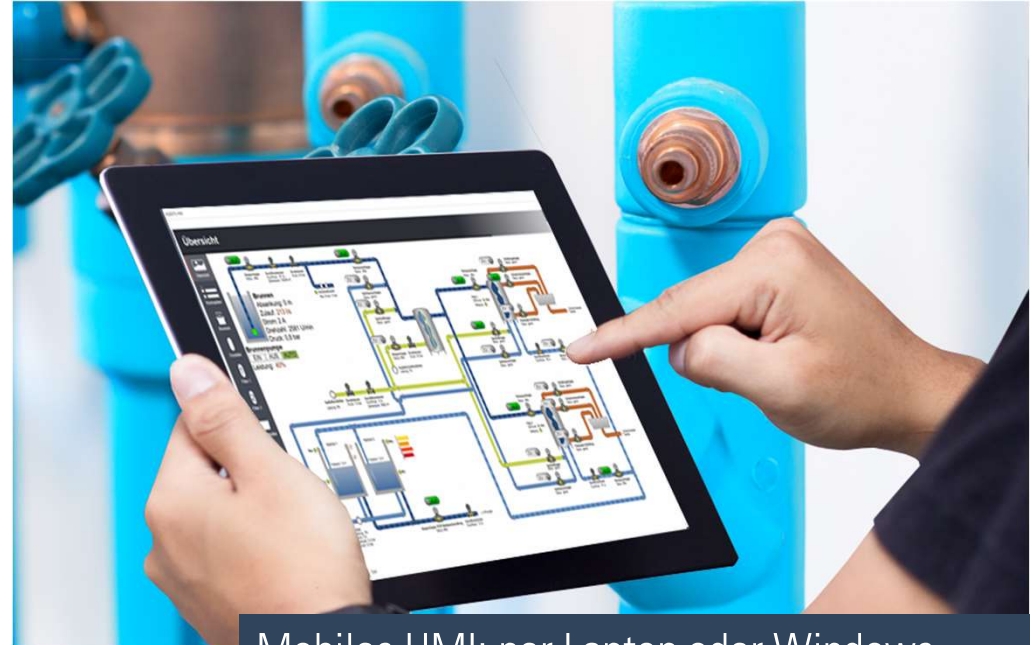
Mobiles HMI: per Laptop oder Windows Tablet ausfallsicher auf Prozesse zugreifen
