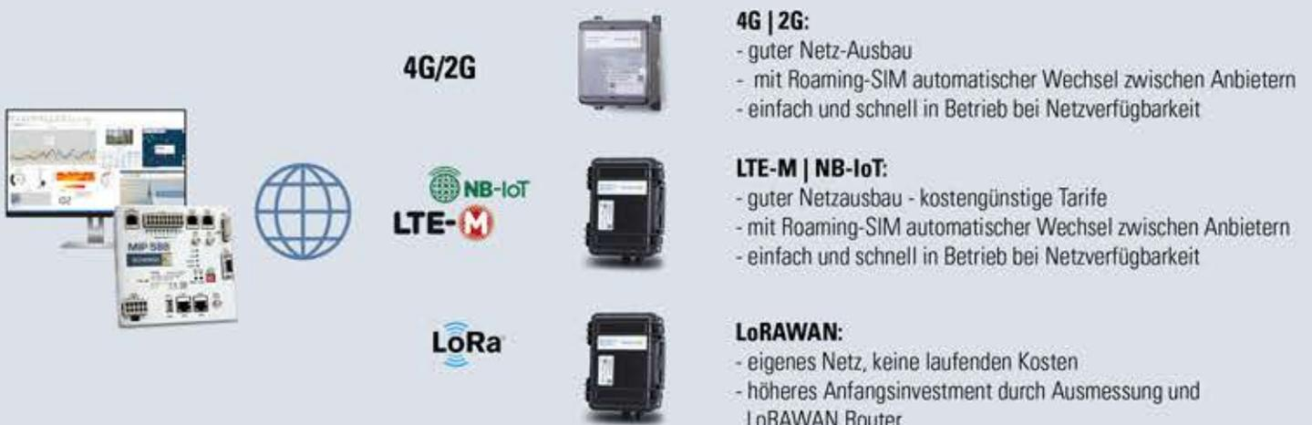
Die Nutzung der Übertragungswege ist bei der FWD Advanced (Batterie/Solar) komplett flexibel und auch einfach wechselbar (modularer Aufbau)
