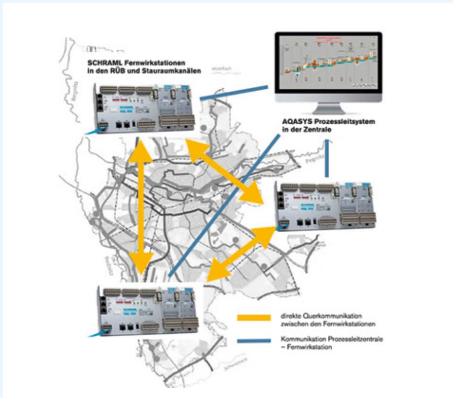
Bild 7 Übersicht Kommunikation Prozessleitzentrale und Fernwirkstationen, im Hintergrund Nürnberger Stadtgebiet
