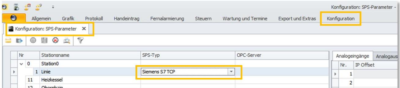
Als **SPS-Typ** wird „Siemens S7 TCP“ ausgewählt. Der SPS-Typ ändert NICHT das Protokoll am MIP, sondern dient nur zur richtigen Anzeige der einzelnen Konfigurationsfelder.
