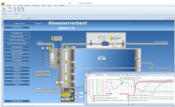
Die Zustände und Trends für jedes RÜB sind auf einen Blick in der Ganglinie erkennbar. Bei Bedarf können die RÜB-Aggregate direkt aus dem Prozessbild heraus schnell und einfach gesteuert werden.
