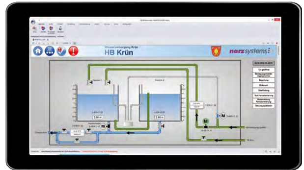
Steuerung des Hochbehälters Krün vom Tablet aus
