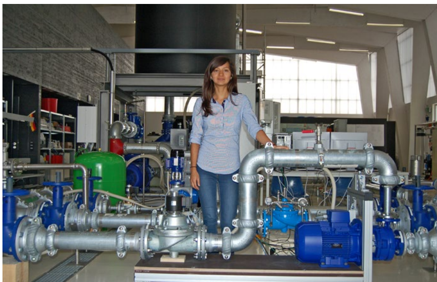
M.Sc. Salomé Parra vor dem „Versorgungsnetz-Simulator“, der Technikums-Anlage der Professur für Siedlungswasserwirtschaft und Abfalltechnik an der Universität der Bundeswehr, München © gwf
