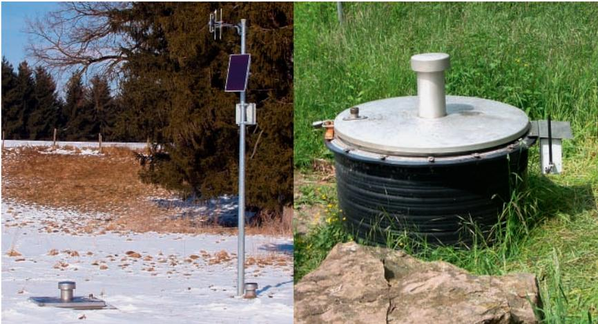
**Bild 4:** Beispiele für den Einsatz des autarken Datenloggers an entlegenen Brunnen oder Deponiesickerwassersammelstellen ohne externe Stromversorgung und ohne traditionelle Datenübertragung (links mit Solarpanel und Akku, rechts batteriebetrieben)
