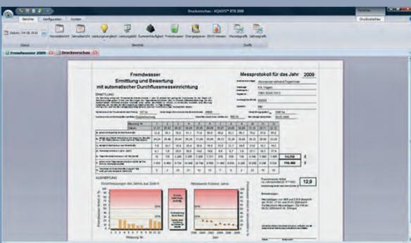
Automatisch generiertes Fremdwasserprotokoll (hier über Nachtminimummessung)
