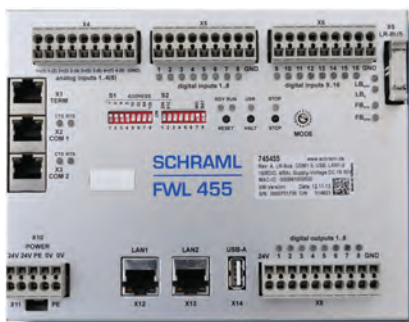
Fernwirkstation als Datensammler, optional mit SPS-Funktion
